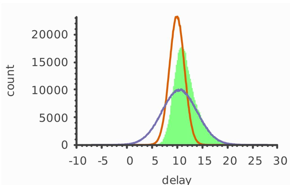
图中红色和蓝色为两个正态分布的概率密度函数曲线，红色为  $N(10, 1.5^2)$ ，蓝色为  $N(10.5, 3.5^2)$ ，绿色阴影部分为对两个正态分布的 **max** 操作进行蒙特卡罗模拟得到的结果。我们可以很明显地看到得出的概率密度分布是一个正偏斜的分布，不符合正态分布的对称特性。
