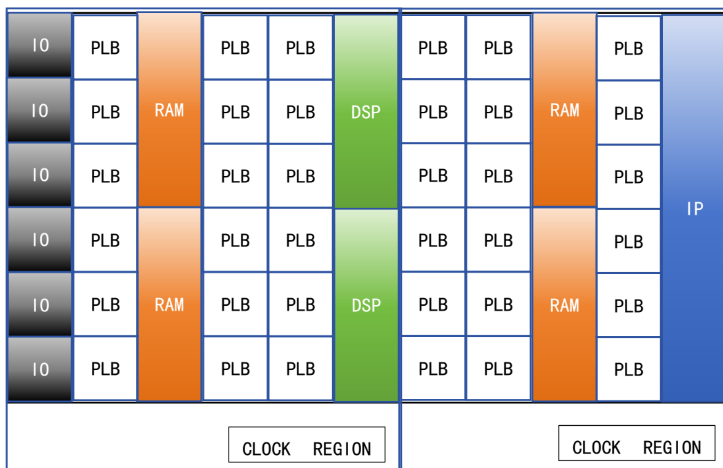
图一 FPGA 逻辑阵列示意图
