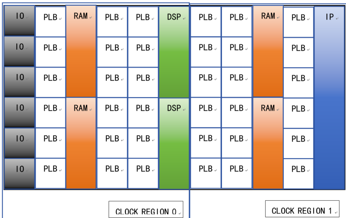
图一 FPGA 逻辑阵列示意图
